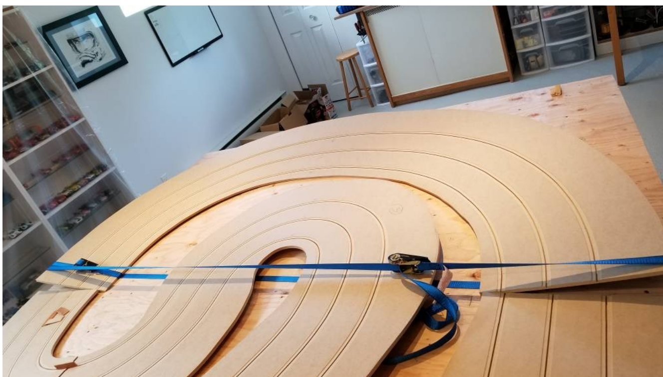
Illustration 19: Exemple de resserrage pour la construction d'un banking [GSR_04]
