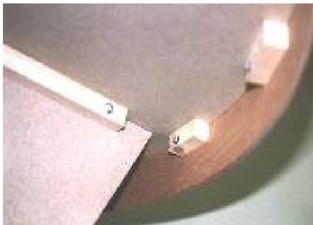
Illustration 27: Détail de fixation pieds double triangles inversés
