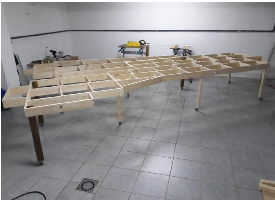
Illustration 30: Ossature treillis pour le TervuRing [GSR_08]
