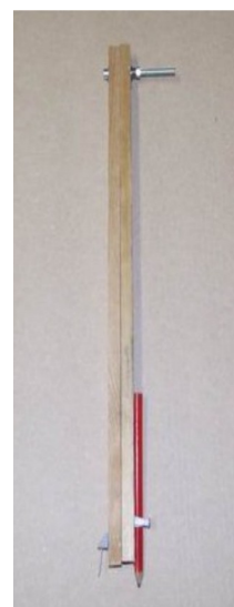
Illustration 6: Un compas maison pour la réalisation du tracé de la piste
